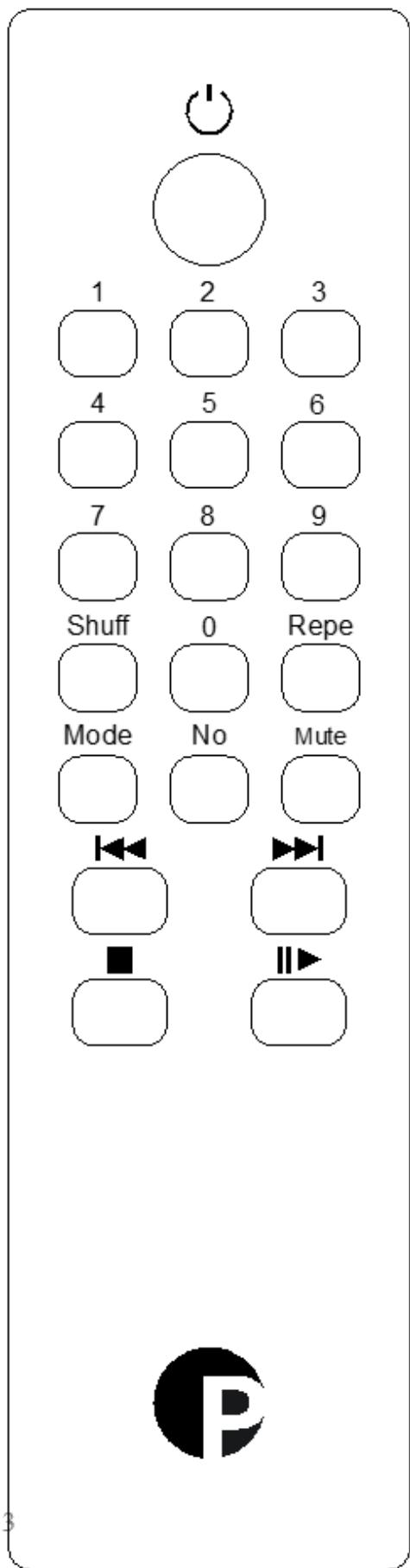
Der oberste Knopf an der Fernbedienung versetzt den CD Player in den Standby Modus bzw. schaltet diesen ein. (Der Ein/Aus Kippschalter muss nach oben geklappt sein)
