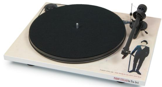
mit Teflonboden für besten Gleichlauf. Das Plattenspielerchassis ist aus einem dichten und dennoch leichten Holzwerkstoff gefertigt. Der Essential II Demon bietet mit dem bewährten aus einem Stück gefertigten 8,6" Aluminium-Tonarm, der Saphir-gelagert ist, die bessere „Plug & Play“- Lösung als das Vorgängermodell. Durch die Spezialfüße wird der Plattenspieler zuverlässig vom Untergrund entkoppelt.
