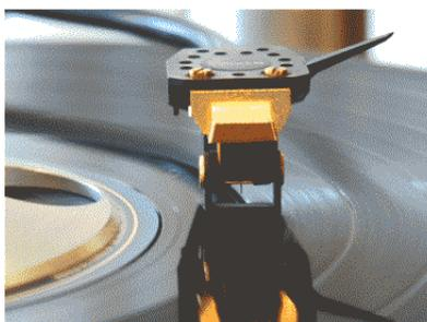
Bei montiertem Nadelschutz und aufgelegter Schallplatte, setzen Sie den Tonarm an den Beginn der Auslaufrille. Stellen Sie jetzt die Wunschhöhe von Q UP auf Ihren Tonarm ein, indem die Unterseite des Tonarms etwa 1,5mm über dem Lifthebel zu liegen kommt.
