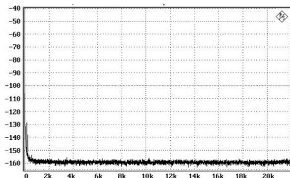
Die Resultate sind nur durch die Möglichkeiten der Messgeräte limitiert, Grundrauschen liegt bei  $-160\text{dB}$  oder sogar niedriger. Es gibt sichtbare Spitzen bei 50Hz und 100Hz welche durch die Limitierungen des Mess-Equipments bedingt sind. Jedoch liegen diese bei  $-130\text{dB}$  und  $-140\text{dB}$ .
