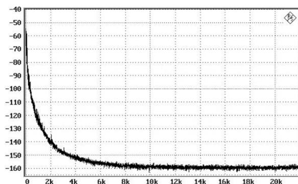
Nach passiver RF Interferenz-Filterung sind die Resultate bereits bemerkenswert. Rauschen bei 1kHz fällt auf  $-125\text{dB}$ , bei 10kHz fällt das Grundrauschen sogar auf  $-160\text{dB}$ . Jedoch verbessern sich diese Messwerte noch weiter nach aktiver Filterung.
