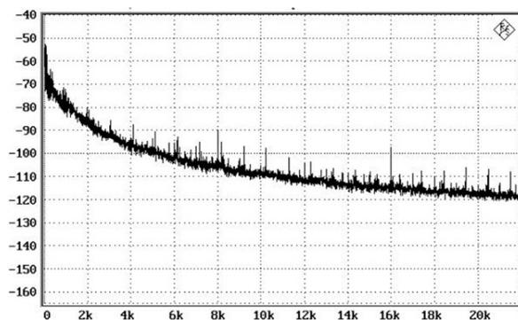
Wir können sehen, dass das Grundrauschen bei 1kHz bei ungefähr  $-75\text{dB}$  und bei 10kHz bei ungefähr  $-110\text{dB}$  liegt.
