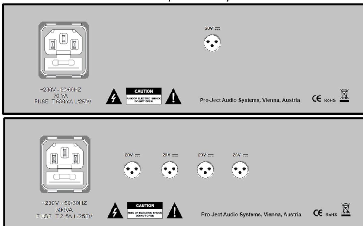
Verbinden Sie mit dem beiliegenden Versorgungskabel die Netzteilbuchse und die Ausgangsbuchse (20V).
