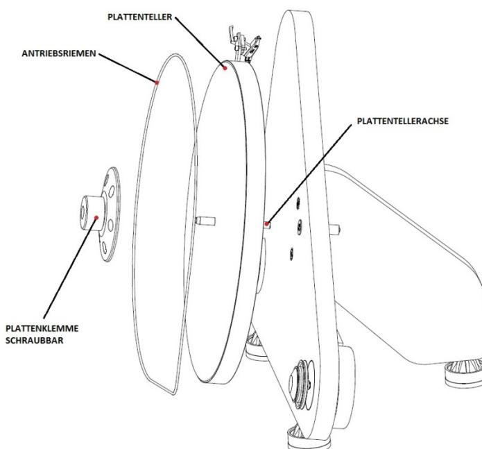
**Nach Platzierung einer Schallplatte auf dem Plattenteller, ist es notwendig die Plattenklemme (6) auf die Tellerachse zu schrauben.**
